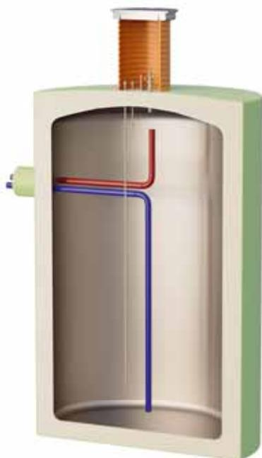
Der Vor- und Rücklaufanschluss wird standardmäßig durch den Mantel und die Mantelisolierung des Wärmespeichers nach außen geführt und münden in einem Schutzrohranschluss /DN200). Die Fühlerrohre und der Entlüftungsanschluss werden durch den Deckel und die Deckelisolierung in den Domschacht geführt und sind nach dem Einbau erreichbar. Bei der Sonderausführung werden Vor- und Rücklauf durch den Deckel in den Domschacht geführt.
