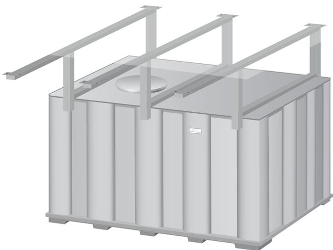
Abbildung 10: Auftriebsicherung, Bsp. standortgefertigter Stahltank
