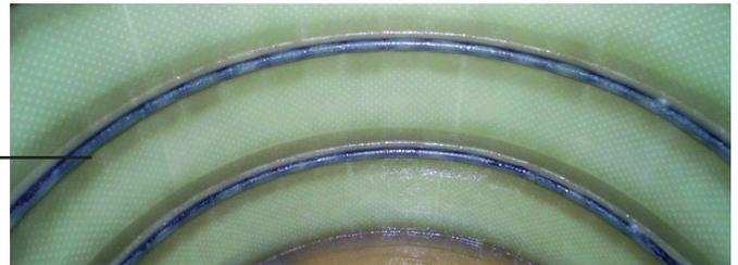
Detail: Verstärkte Wandung durch zusätzliche Versteifungsringe
