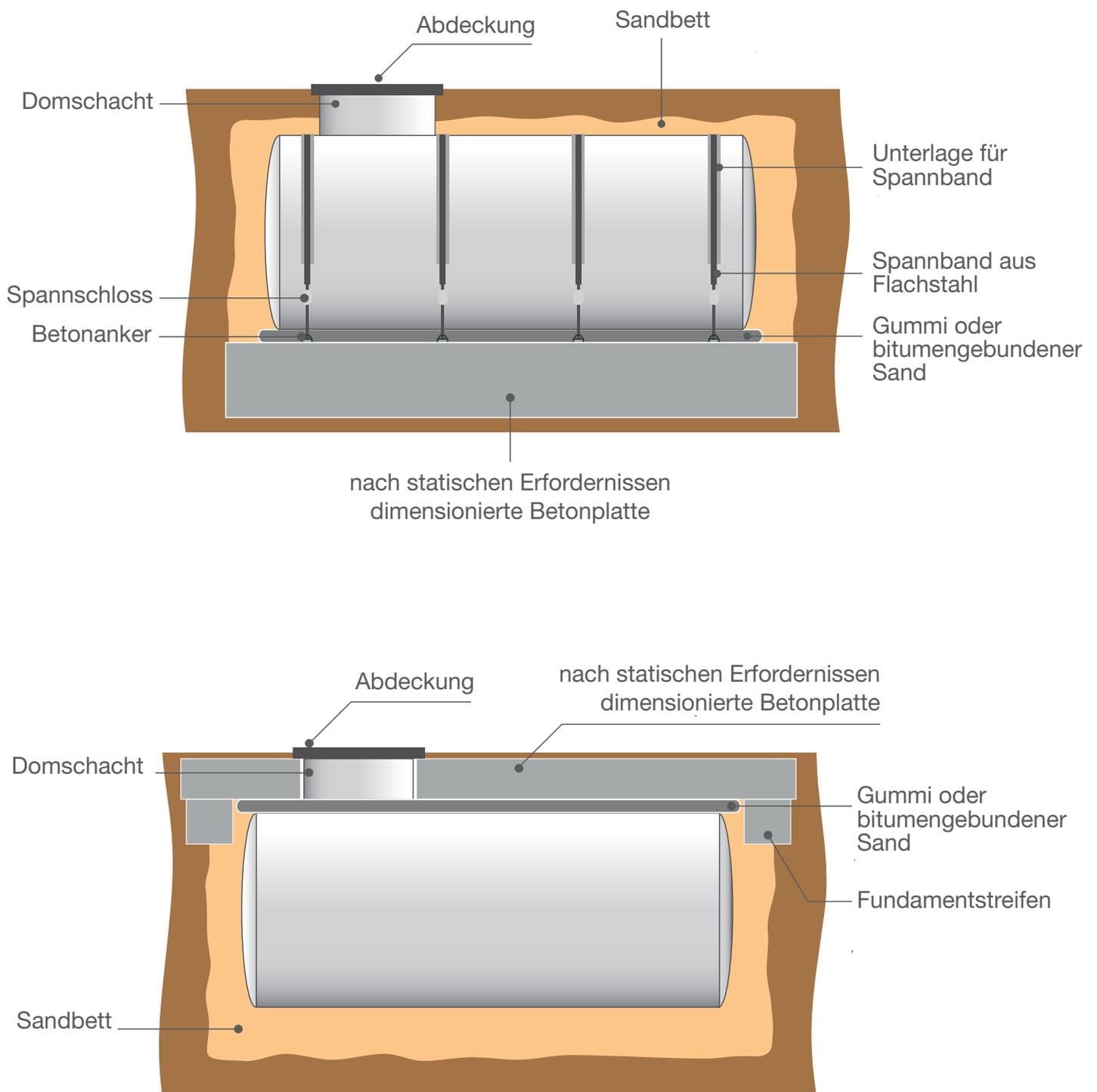
Abbildung 5: Auftriebsicherung unterirdischer Öltank nach DIN 6608
